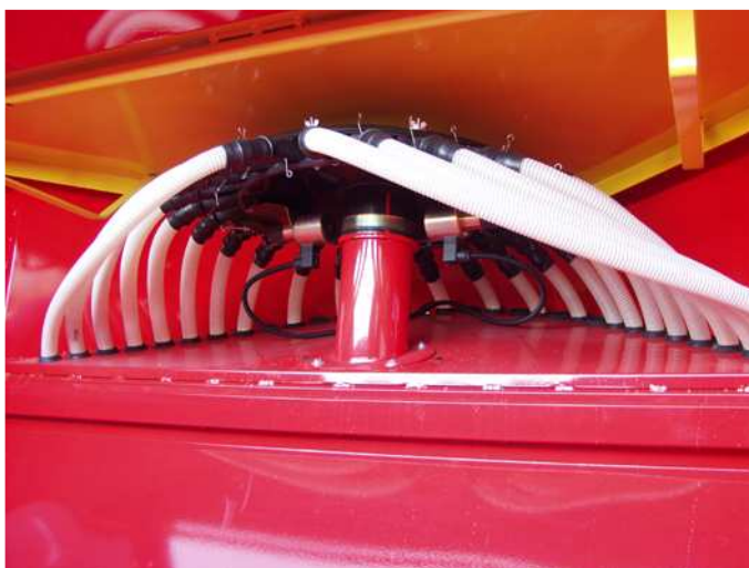
La semilla regresa a la tolva con los marcadores de línea conectados
