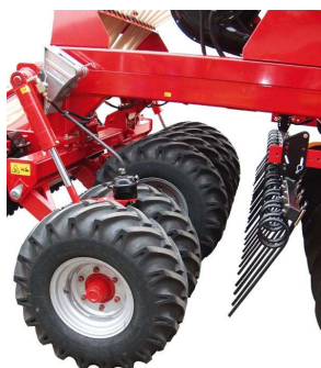
La mitad de las ruedas compactadoras desacopladas
