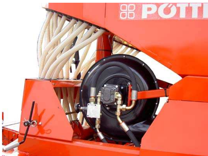
Regulador hidráulico en la turbina
