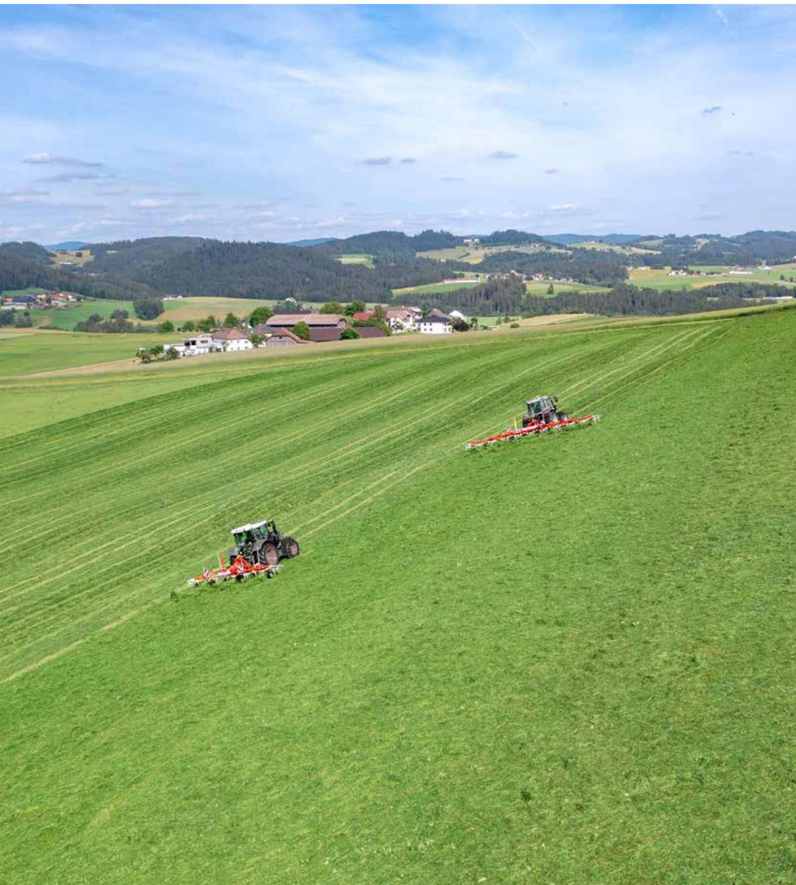
Independiente si en ensilado o heno, en terrenos llanos o accidentados - los rastrillos henificadores HIT de PÖTTINGER siempre tienen una buena presencia. La innovadora técnica de rotores DYNATECH aporta un henificado limpio y máximo cuidado del forraje. La adaptación al suelo funciona de la manera habitual de PÖTTINGER - requisitos ideales para la cosecha de forraje de calidad.
