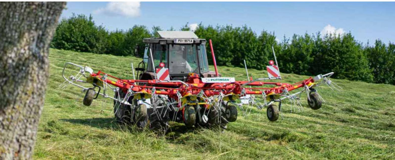
En las cabeceras existe el peligro que con la máquina elevada, los rotores exteriores raspen en el suelo y dañen la capa de la hierba. Según necesidad y altura de elevación del tractor, PÖTTINGER ofrece para cada modelo unos sistemas perfectamente adaptados para dejar suficiente distancia al suelo. Se protege la capa de hierba y el forraje no se contamina.
