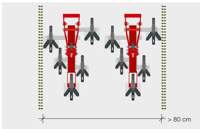
Con cinco herramientas de azada se pueden realizar distancias entre hileras de 55 hasta 80 cm. Así por ejemplo se puede estimular el crecimiento de maíz o girasol.
