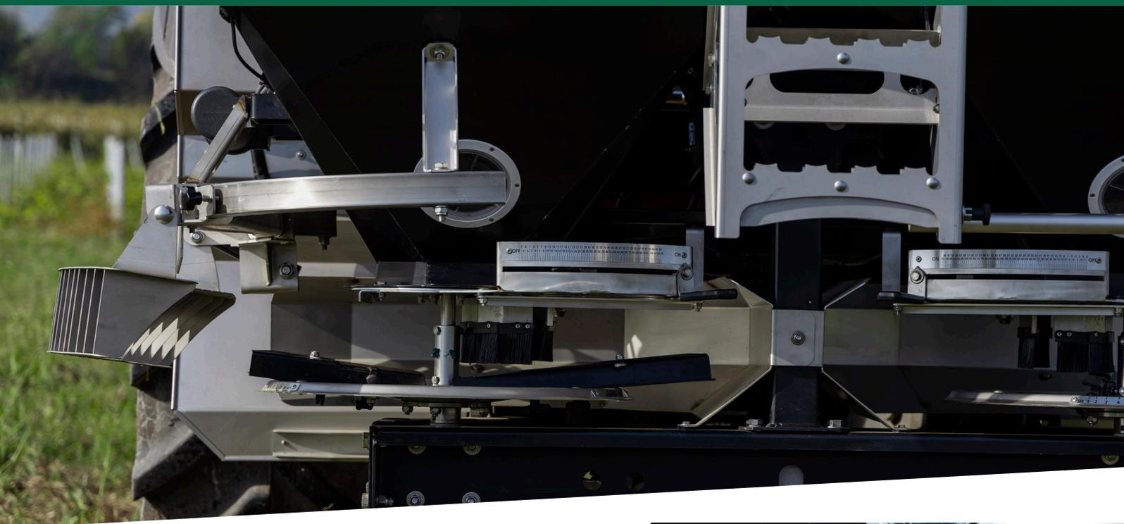
TODOS los componentes en contacto directo con el fertilizante (fondo de la tolva, rejillas de protección, compuertas de apertura y cierre, discos esparcidores, paletas de dispersión, carcasa protectora, pernos y agitadores) están realizados en ACERO INOXIDABLE.
