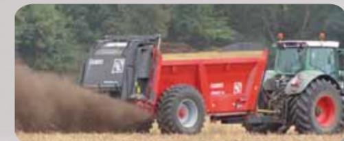
Le système ROTOMAX est conçu pour épandre tout type de fumiers et composts, de 5 à 70 T/ha. Lors d'opérations spécifiques, il peut être équipé d'une hotte d'épandage ou de compostage. La table d'épandage MAXXIS est étudiée pour épandre des fientes, des boues, de la chaux, des composts, à faible dosage de 1 à 30 T/ha. La régularité et la précision de ces systèmes peuvent être améliorées par l'ajout de DPA, calculateur, pesée, etc...
