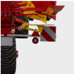
Señalización con iluminación
