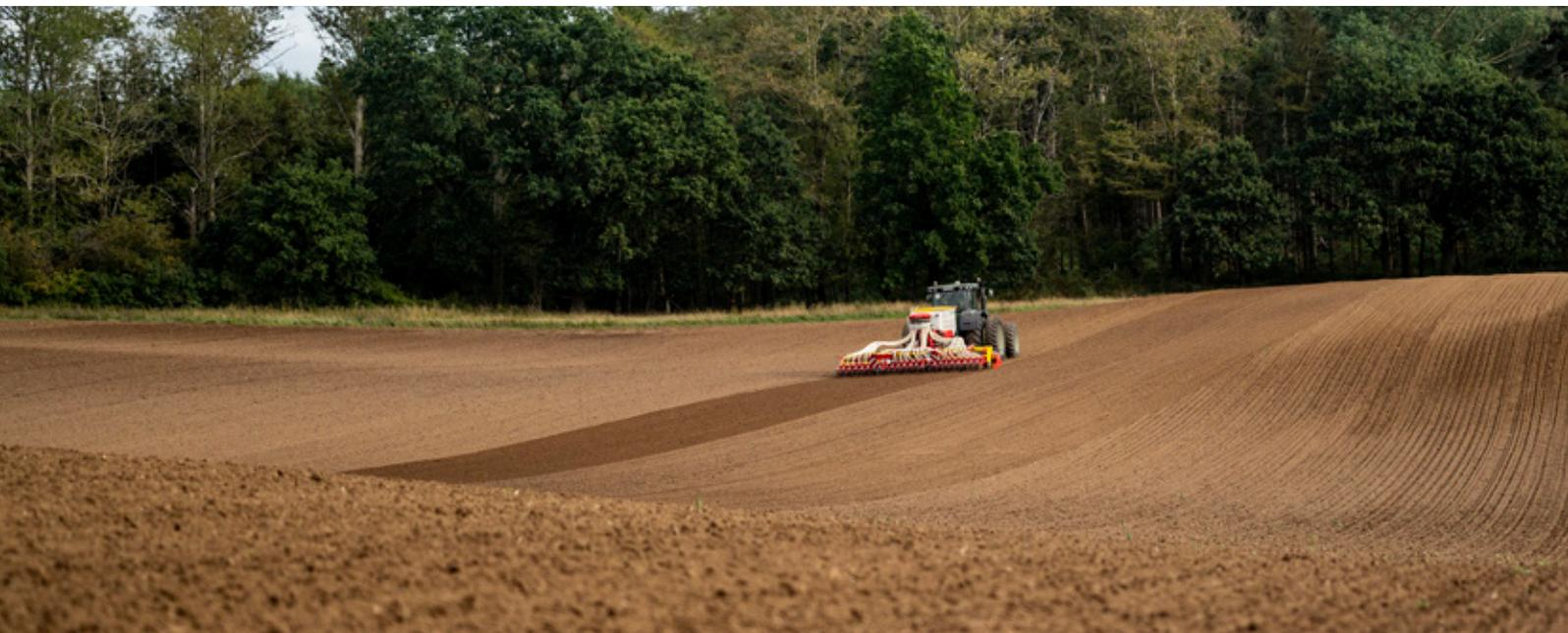
Profiline es el confort de controlar todas las funciones hidráulicas en la AEROSEM. La máquina recibe aceite mediante la línea Load Sensing y todas las herramientas se controlan mediante un bloque hidráulico. Mediante el mando confort Profiline se puede adaptar la máquina a las condiciones del campo, tanto la grada rotativa como la presión de las rejas de la AEROSEM durante la conducción.
