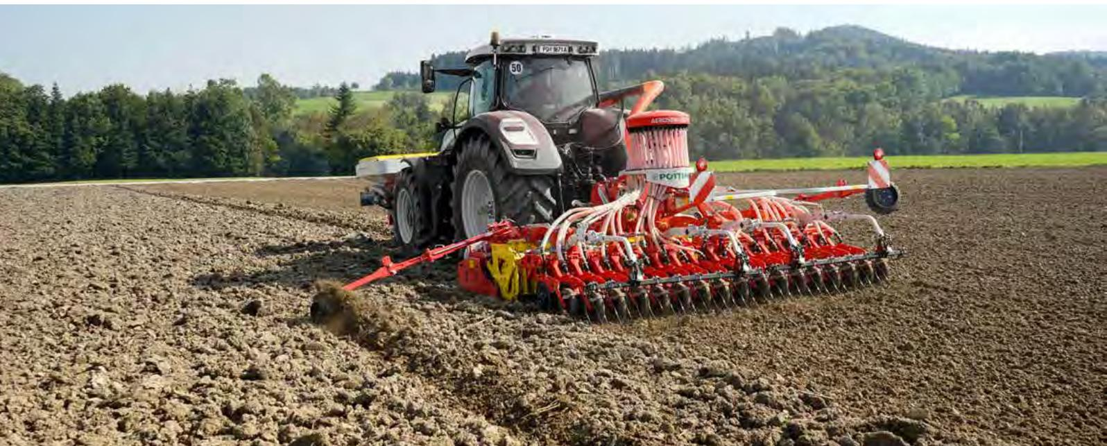
Con la sembradora con depósito frontal AEROSEM F, PÖTTINGER amplía la gama de sembradoras neumáticas suspendidas con un ancho de trabajo de hasta 6 metros.
