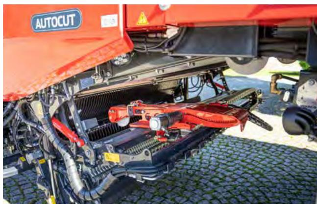
Un corte exacto y uniforme es la base para conseguir la mejor calidad de ensilado. El dispositivo de afilado de cuchillas AUTOCUT asegura una calidad de corte duradera durante todo un día de trabajo. Las cuchillas se afilan de forma cómoda y rápida directamente en el remolque autocargador, lo que reduce de forma considerable el gasto de combustible y el mantenimiento.
