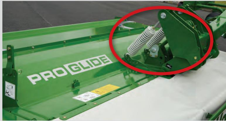
Los muelles de la suspensión trasera Pro Glide reaccionan al instante a los desniveles del terreno, lo que da como resultado una alta calidad de corte incluso al trabajar a altas velocidades. Esto permite que la segadora trabaje fácilmente en terrenos difíciles, permitiendo unos resultados óptimos.
