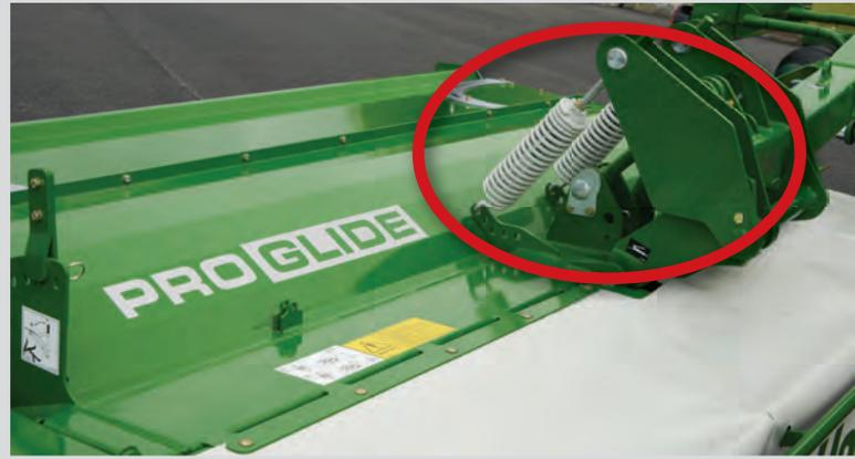
Los muelles de la suspensión trasera Pro Glide reaccionan al instante a las irregularidades del terreno, lo que da como resultado una alta calidad de corte incluso al trabajar a elevadas velocidades. Esto permite que la segadora corte fácilmente en terrenos abruptos, permitiendo unos resultados óptimos.
