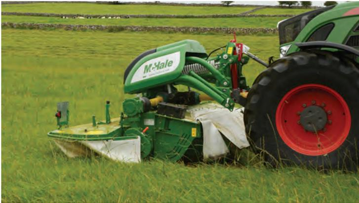
El equipo de McHale ha diseñado el chasis de la segadora frontal Pro Glide para ubicar el centro de gravedad lo más cerca posible al tractor, lo que permite una respuesta única a los cambios en el terreno.
