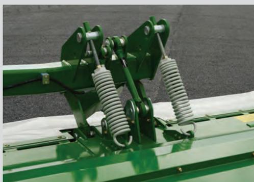
La mayoría de las segadoras traseras tienen un bulón central que permite a la segadora moverse a la izquierda y a la derecha para adaptarse al terreno. La McHale Pro Glide es diferente, dispone de un patentado sistema de suspensión de seguimiento 3D del terreno, que permite a la segadora:
