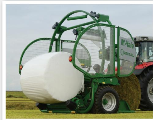
Al descargar la paca, el rodillo de encintado trasero baja y la encintadora McHale Orbital deposita la paca encintada con cuidado en el suelo.
